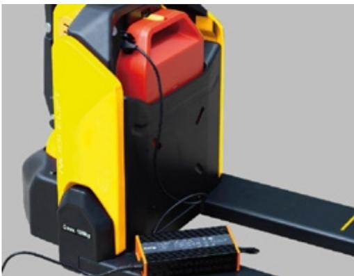
El equipo posee un enchufe en la caja de la batería para iniciar la carga sin necesidad de sacar la batería.
