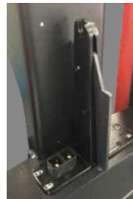
El posicionamiento de la batería dentro del compartimento es rápido y fácil gracias al sistema de guía especialmente diseñado.
